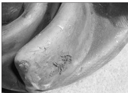
Ilustracja 3. Jeden z pierwszych gumowanych wirników wykazał ślady zużycia podczas testu. Takie badania prowadziły do dalszego rozwoju nowej technologii.
