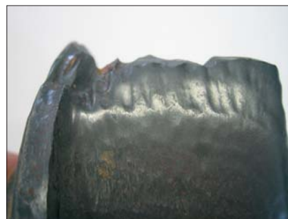
Ilustracja 1. Niezabezpieczone tradycyjne wirniki z żeliwa ulegają ścieraniu wskutek abrazyji
