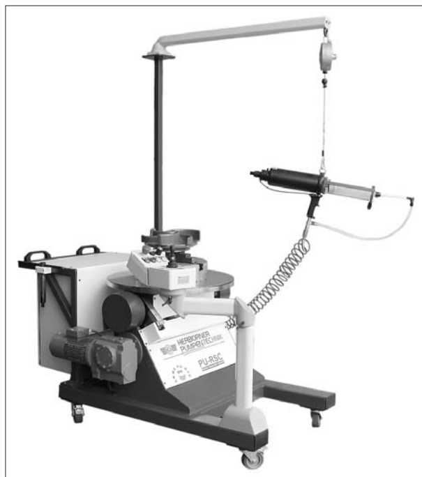
Ilustracja 5. Urządzenie do równomiernego nanoszenia powłoki gumowej na wirniki pomp
